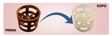
Il trattamento agisce direttamente sul problema, ammorbidendo e dissolvendo i depositi e la relativa contaminazione. Come supporto possono essere utilizzati altri sistemi di riabilitazione quali spazzolatura e pistonaggio, air-lift e ricircolo con pompa sommersa inserita. Successivamente le acque di reazione andranno eliminate con un adeguato spurgo.
